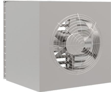
Alle am Laufrad befindlichen Komponenten sind aus Aluminium gefertigt und werden einem Durchdringungstest und einer Röntgenüberprüfung unterzogen. Die Schaufeln sind im Stillstand stufenlos verstellbar. Die Nabe mit Bohrung ist dynamisch ausgewuchtet nach DIN ISO 1940-1, Wuchtgüte Q = 6,3.
